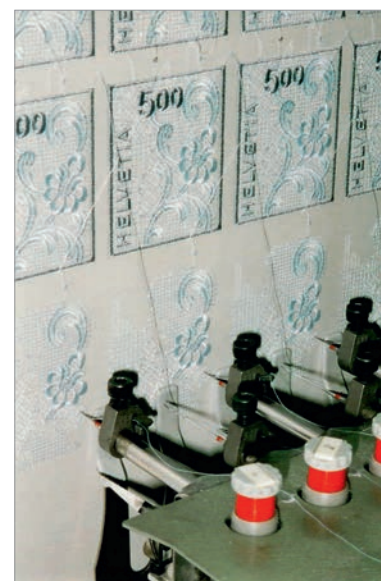
Produktion und Qualitätskontrolle der Stickereimarke auf einem 10 Meter breiten SAURER Stickautomaten bei der Fa. Bischoff-Textil AG in Diepoldsau (SG).
